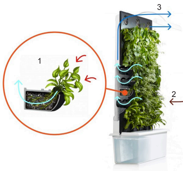
Рис. 6. Схема функционирования фитостены «Freshwall». 1 – модуль-бокс (контейнер) с растением; 2 – воздух из помещения; 3 – очищенный воздух.
